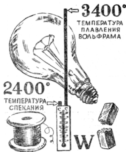
После спекания из вольфрама вытягивают тончайшую проволоку, используемую для изготовления электрических ламп.
