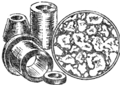
Методами металлокерамики изготавливаются пористые втулки подшипников. В кружке — микроструктура сплава.
